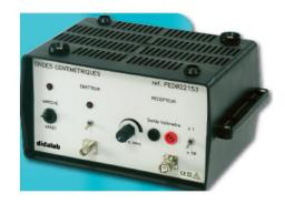
Le circuit amplificateur de la diode détectrice (constitué d'un amplificateur opérationnel délivrant une tension amplifiée rigoureusement proportionnelle à l'énergie hyperfréquence reçue par la diode) permet de faire la mesure sur un voltmètre classique.
