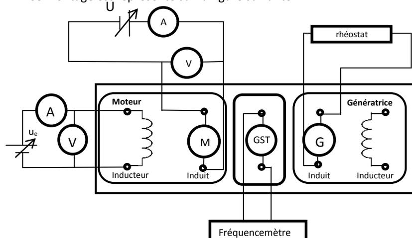
Le moteur est chargé par une génératrice qui fournit de l'énergie électrique à un rhéostat. Attention :
