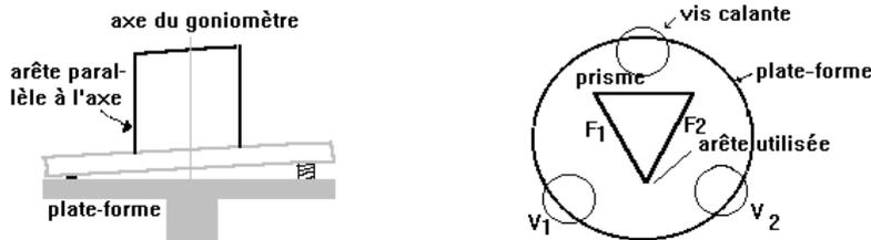
Placer le prisme de façon à avoir une vis calante face à chaque face. Effectuer une autocollimation sur la face  $F_1$  et régler la vis  $V_1$  pour que le fil horizontal du réticule coïncide avec son image. Faire de même sur la face  $F_2$  avec la vis  $V_2$ . Reprendre les manœuvres sur  $F_1$  puis  $F_2$  jusqu'à un réglage précis. *Ne pas utiliser la troisième face du prisme.*
