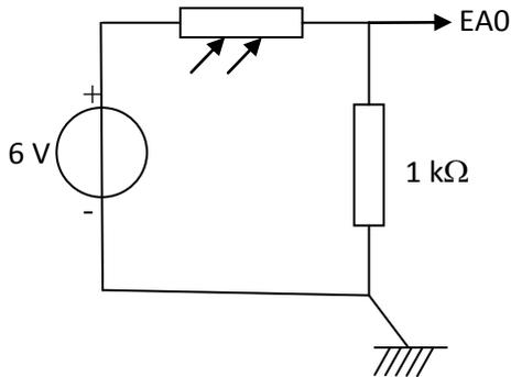
Le potentiel EA0 varie entre 3 Volts (photorésistance éclairée par le laser) et 1 volt (faisceau laser coupé).
