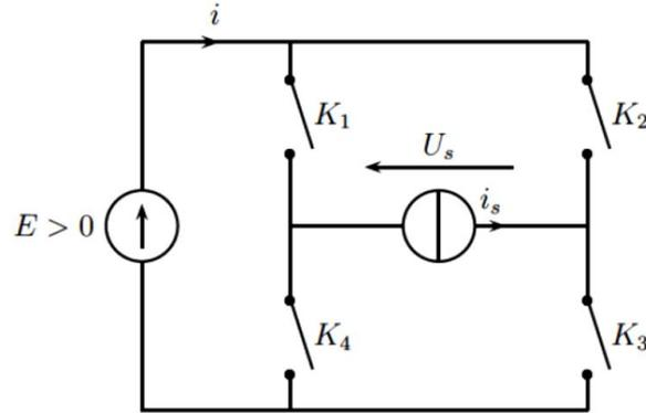
FIGURE 6 – Onduleur de tension à deux niveaux.
