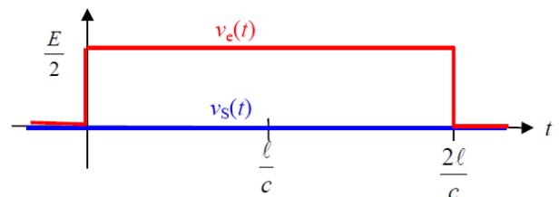
• Si  $R_U = R_C$ ,  $\alpha = 0$  : il n'y a pas d'onde réfléchie donc  $v_s(t) = v_e\left(t - \frac{\ell}{c}\right)$  avec  $v_e(t) = v_1(t) = \frac{E}{2}$  quel que soit  $t \geq 0$ . On en déduit les courbes ci-contre :
