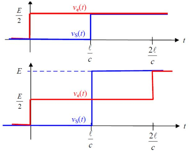
• Si  $R_U = \infty$ ,  $\alpha = 1$ . Pour  $t \geq t_1$ , il existe une onde réfléchie, d'amplitude  $\frac{E}{2}$  donc  $v_s = v_1 + v_2 = E$  pour  $t \geq t_1$ . Cette onde réfléchie atteint l'extrémité  $z = 0$  à l'instant  $t_2$  donc  $v_e = E$  pour  $t \geq t_2$ . On en déduit les courbes ci-contre :
