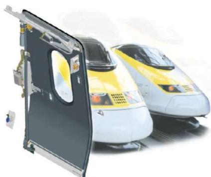
La figure de droite montre l'interface assurant, à partir des informations délivrées par l'unité centrale de commande, la fermeture hermétique et le verrouillage d'une porte de TGV.
