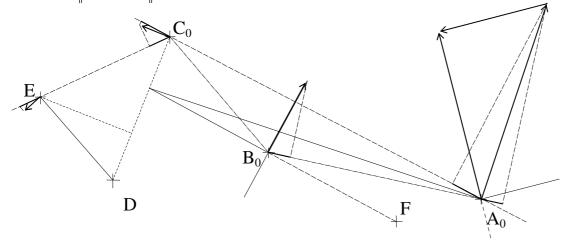
II-2 suite:  $\overrightarrow{V}(E \in 3/0) \perp DC \ 3 \text{ et } 0 \text{ en liaison pivot en } D$
