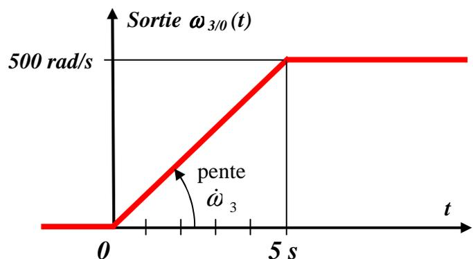
Calcul de  $\dot{\omega}_3$  (pente de la courbe) : la phase d'accélération (entre 0 et 5 s) se fait à accélération constante  $\dot{\omega}_3$ , d'où :
