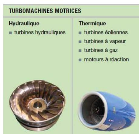
Ces turbomachines sont différentes, dans la conception et dans l'application des lois physiques, des machines dites « volumétriques », où le fluide échange de l'énergie par variation de volume due à un piston ou un plongeur. Dans les machines vues en première année, les pompes à chaleur, réfrigérateurs, climatiseurs sont des machines à écoulement ; par contre les moteurs thermiques de type moteur à explosion ou diesel sont des machines volumétriques.
