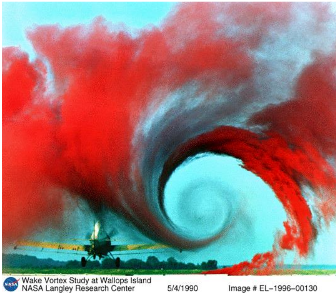
Lignes d'émission d'un tourbillon de bout d'aile visualisé par ses lignes d'émission
