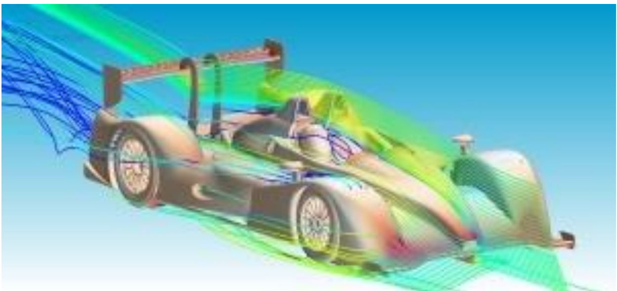
SIMULATION DE LIGNES D'EMISSION A L'AIDE D'UN LOGICIEL
