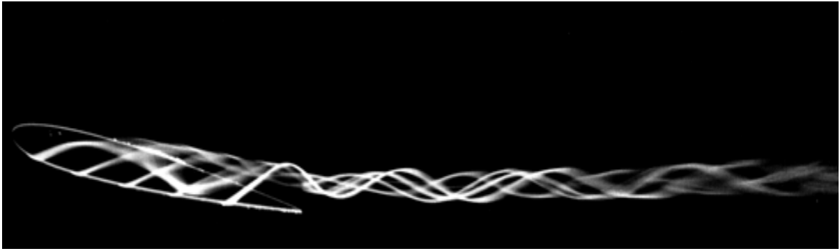
LIGNES D'EMISSION AUTOUR D'UN PROFIL D'AILE
