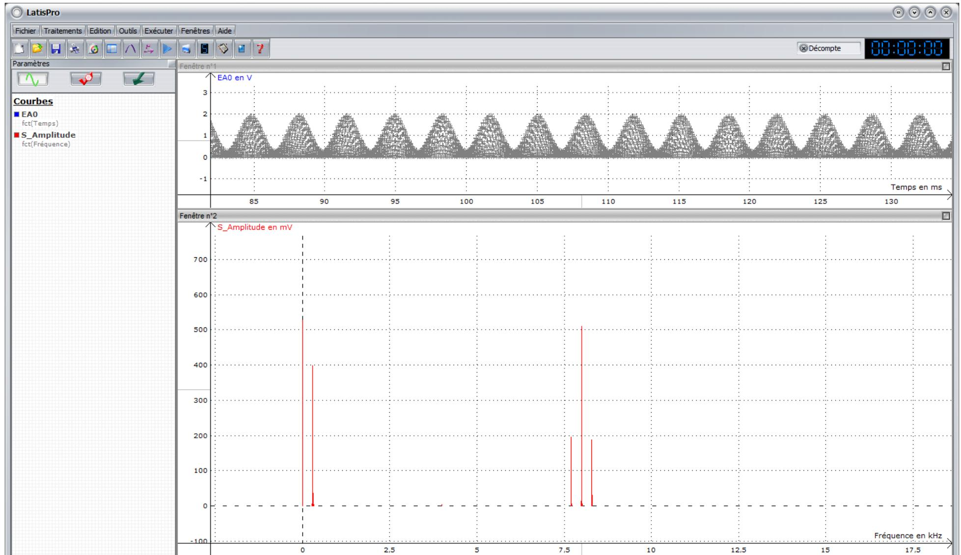
Il n'y a plus qu'à filtrer d'abord avec un passe-bas qui coupe les fréquences hautes  $f_p$ ,  $2f_p \pm f$
