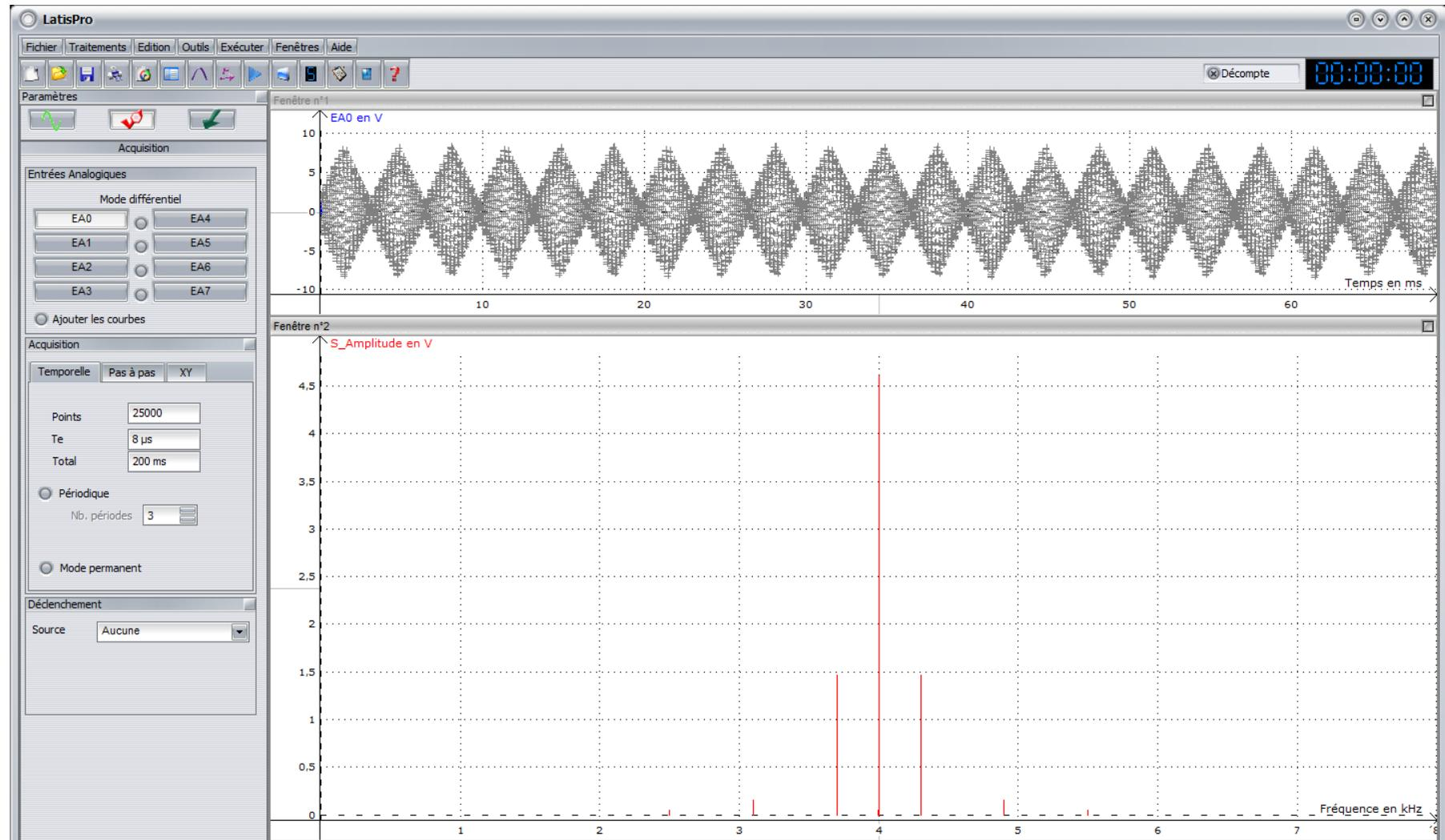
On a réalisé ensuite le produit d'un signal porteur sinusoïdal de fréquence 4 kHz par un signal modulant triangulaire de fréquence 1,5 kHz environ et l'on a ajouté le signal porteur à ce produit.
