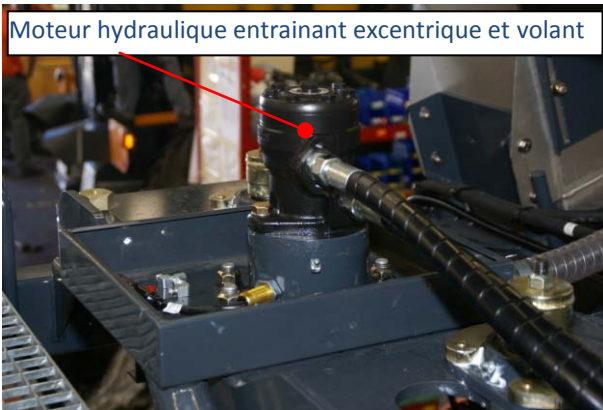
Figure 3.3 : Solution à moteur hydraulique, vue du moteur
