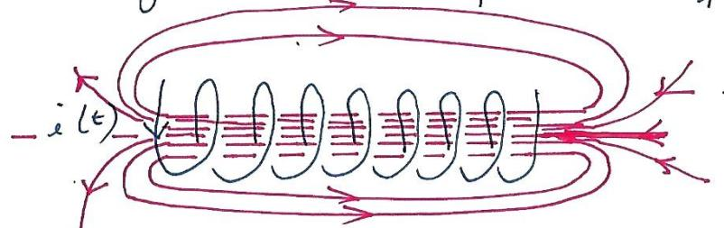
La forme de ces lignes explique l'augmentation ou la diminution du flux de  $\vec{B}_1$  à travers les spires de  $B_2$  suivant la position relative de  $B_1$  à  $B_2$  ainsi que le déphasage éventuel.
