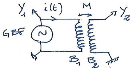
GBF: signal sinusoïdal d'amplitude et de fréquence variable
