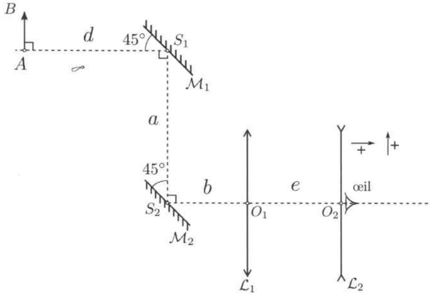
1. L'objet  $AB$  est placé à grande distance du périscope (suffisamment loin pour que  $d$  puisse être considéré infini). On note  $e_0$  la valeur de  $e$  permettant à l'œil d'observer  $AB$  à travers  $S_p$  sans accommoder. Exprimer  $e_0$  :
