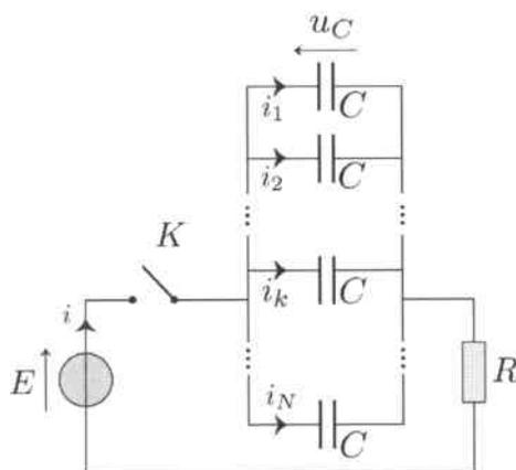
25. Que vaut l'énergie totale  $\mathcal{E}_e$  emmagasinée par les condensateurs, avant la fermeture de  $K$  ?
