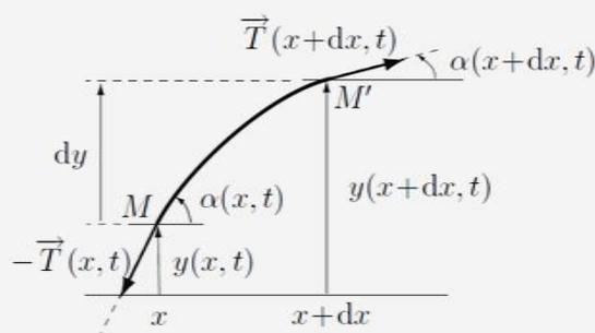
Puisque le poids est négligé, l'élément de corde, de longueur  $d\ell \simeq dx$ , de masse  $dm = \mu d\ell$ , est soumis à :
