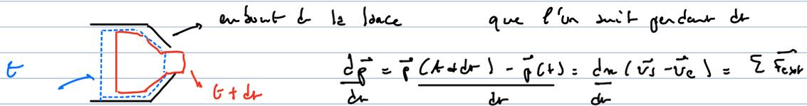
En project. sur Ox:  $Dm(v_s - v_e) = F_{\text{embout} \rightarrow \text{eau}} + F_{\text{pression} \rightarrow \text{eau}}$
