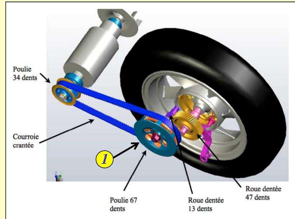
$$H_3(p) = \frac{\Omega_r(p)}{\Omega_m(p)} = \frac{\Omega_r}{\Omega_1} \times \frac{\Omega_1}{\Omega_m} = \left( -\frac{Z_{\text{petite roue dentée}}}{Z_{\text{grande roue dentée}}} \right) \times \frac{Z_{\text{petite poulie}}}{Z_{\text{grande poulie}}} = -\frac{13}{47} \times \frac{34}{67}$$
