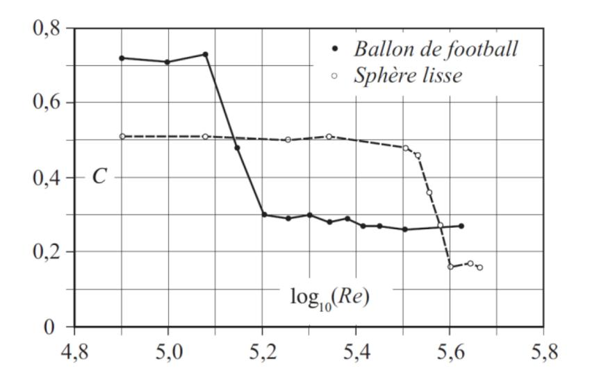
FIG. 5 – Essai comparatif en soufflerie
