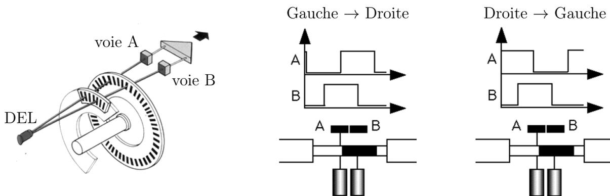
Figure 10 – Principe de fonctionnement d'un codeur incrémental
