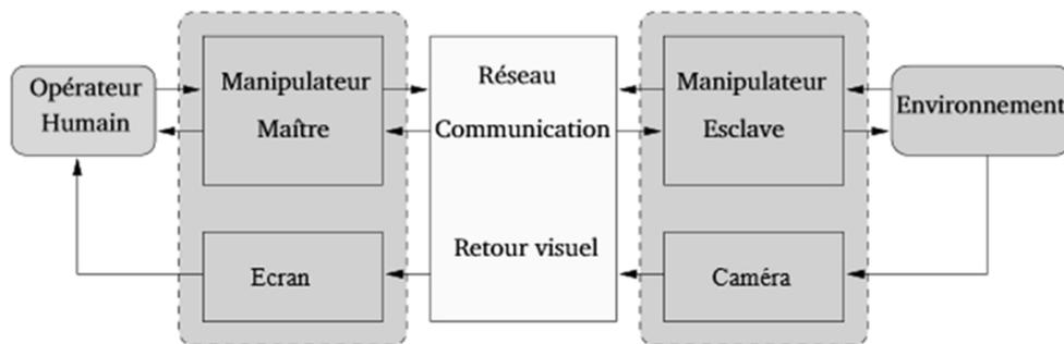
Figure 1 – Schéma de principe de la téléopération
