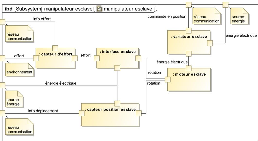
Figure 11 – Diagramme de blocs internes du manipulateur esclave
