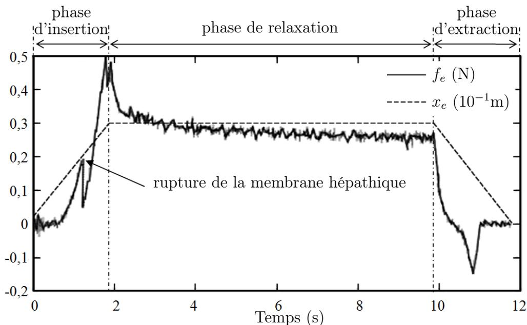
Figure 15 – Pénétration d’une aiguille dans le foie d’un porc
