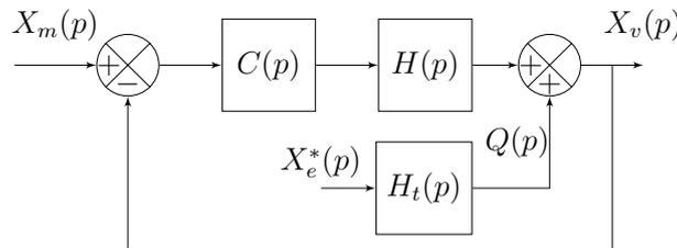
Figure 20 – Modélisation simplifiée du dispositif esclave
