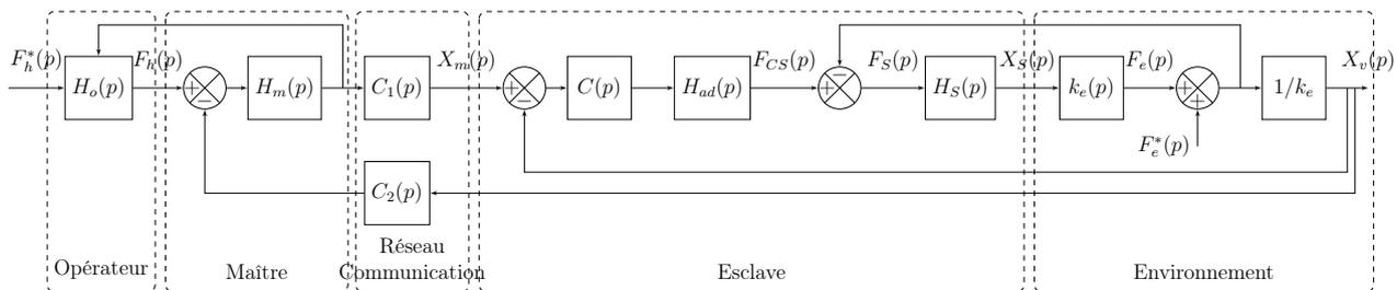
Figure 14 – Schéma bloc simplifié de la commande
