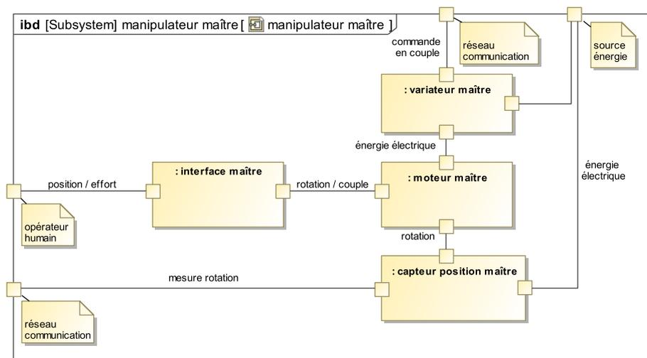
Figure 3 – Diagramme de blocs internes du manipulateur maître
