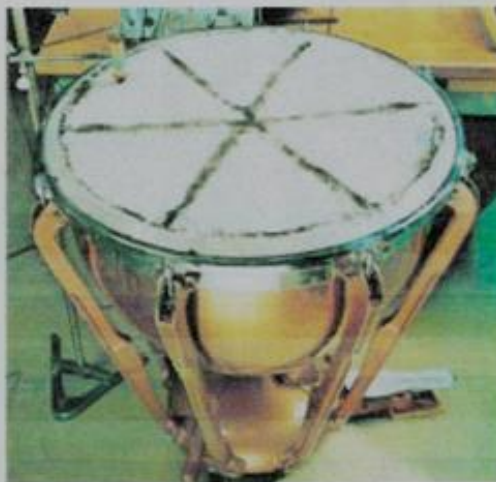
la peau du tambour. Il fait vibrer un petit aimant situé sous la peau de ce tambour. De haut en bas et de gauche à droite, les modes sont (0,1), (0,2), (1,2), (2,1), (2,2) et (3,1).
