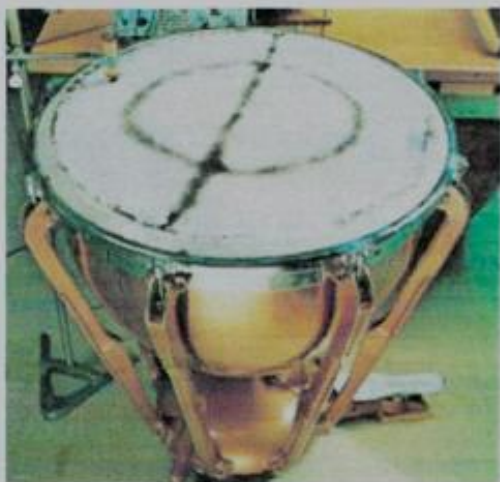
1. MODES DE VIBRATION D'UN TAMBOUR. La poudre noire se rassemble sur les lignes nodales où l'amplitude de vibration est nulle. Le dispositif excitateur est constitué d'un bras touchant presque
