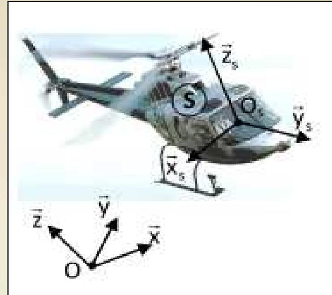
→  $\left\{ \begin{array}{l} \text{définir la position de l'origine } O_S \\ \text{définir l'orientation de la base } B_S(\vec{x}_S, \vec{y}_S, \vec{z}_S) \end{array} \right.$
