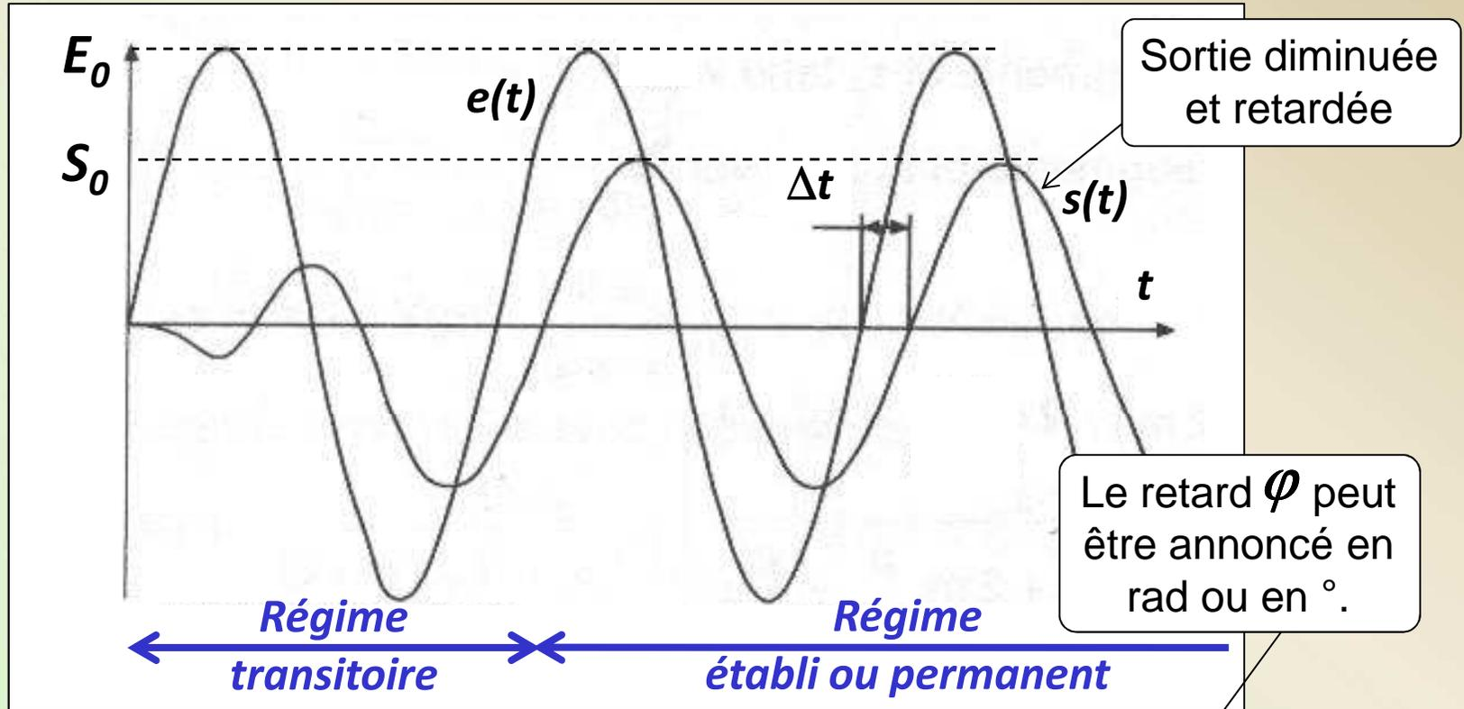
$e(t) = E_0 \times \sin(\omega.t)$        $s(t) = S_0 \times \sin(\omega.t + \varphi)$       avec       $\varphi = \Delta t \times \omega$
