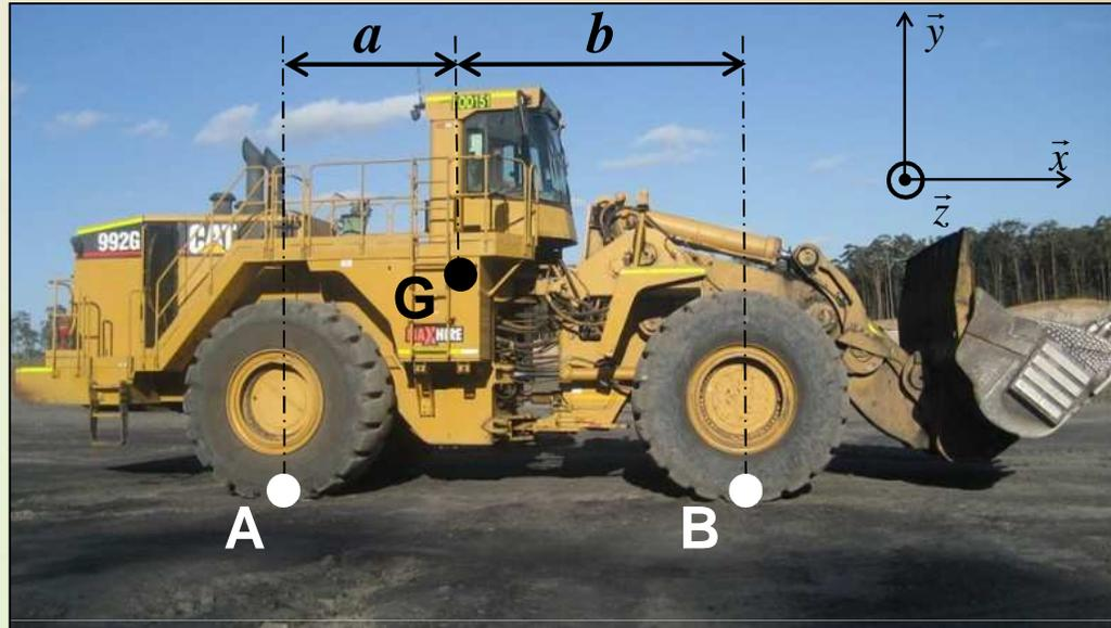
Problème posé : calculer les actions au niveau des deux essieux en A et B en les supposant verticales.
