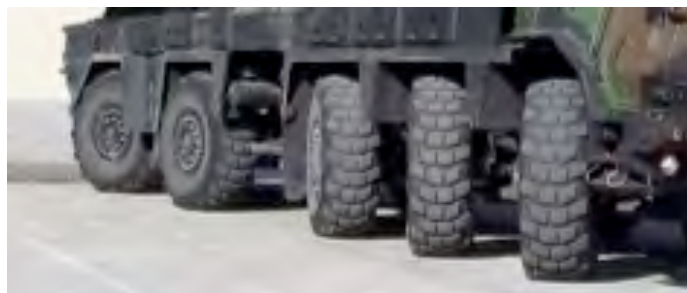
Figure 4 : système à cinq essieux constituant le ponteur
