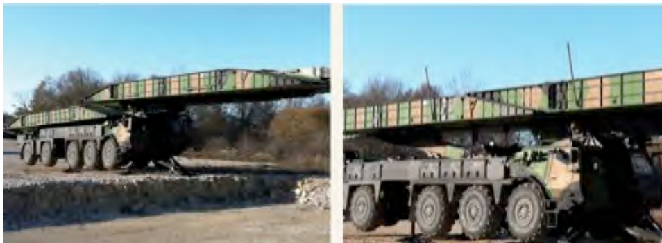
Figure 16 : assemblage de deux travures sur le ponteur
