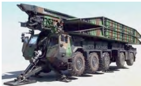
Figure 12 : ponteur en appui sur les stabilisateurs
