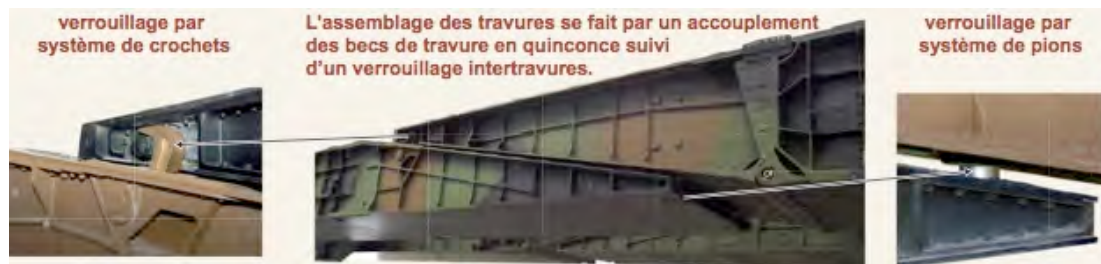
Figure 18 : représentation du système de verrouillage inter-travures
