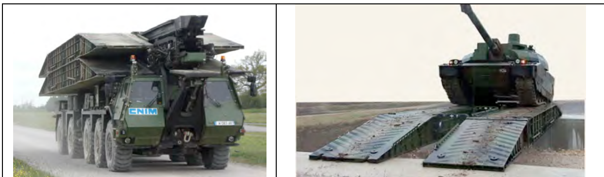
Figure 2 : Ponteur chargé de quatre travures (gauche) et travures assemblées permettant le franchissement d'une brèche (droite)
