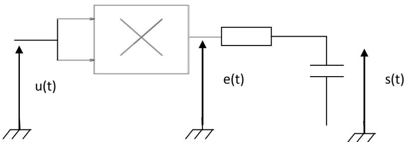
Le multiplieur permet d'obtenir  $e(t) = \frac{1}{U_0}u^2(t)$ , où  $U_0 = 10\text{ V}$ .
