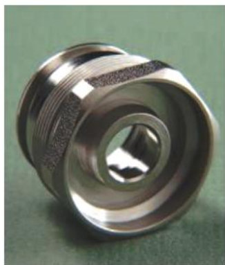
Pièce nickelée par électrolyse
