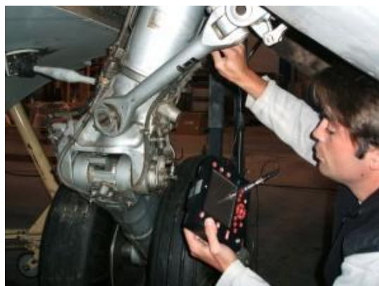
Recherche d'amorce de rupture sur un train d'atterrissage
