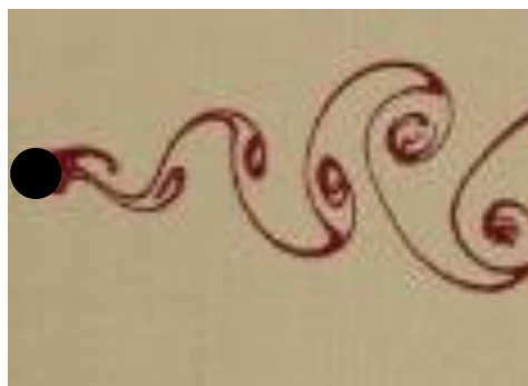
LIGNES D'EMISSION AUTOUR D'UN CYLINDRE
