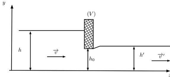
L'écoulement est considéré stationnaire, incompressible, parfait et l'eau est considérée comme un fluide pesant. On notera  $v$  et  $v'$  les vitesses uniformes respectivement en amont et en aval de la vanne ( $V$ ).  $P_0$  est la valeur de la pression atmosphérique au niveau des surfaces libres.
