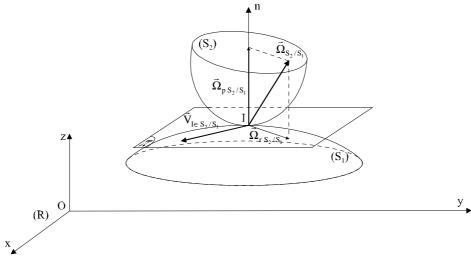
On suppose que les solides admettent un plan tangent  $(\pi)$  au point de contact I, la normale n étant orientée de  $(S_1)$  vers  $(S_2)$ .
